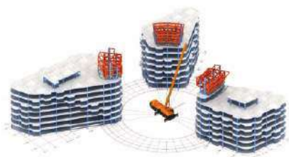
钢梁及桁架原位安装
