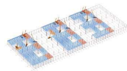
网架单元空洞高空散装补装
