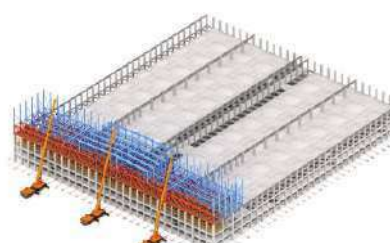
依次安装完成首个整体滑移单元
