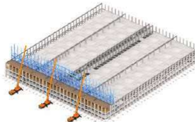
滑移第一个安装单元桁架（两榀）
