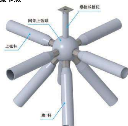
螺栓球檩托连接节点大样图
