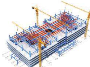
安装屋面钢柱及钢梁
