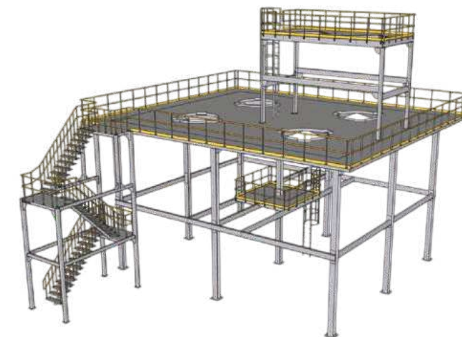
钢结构工作平台
