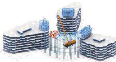
连续安装支撑胎架及桁架单元
