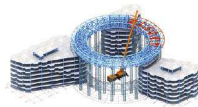
安装次桁架、补装其它杆件
