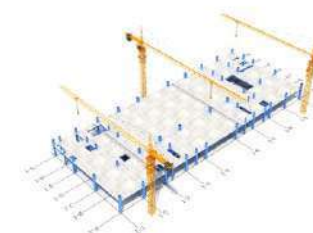
铺设楼承板并浇筑混凝土
