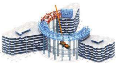
依次安装第二段空中桁架
