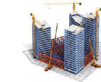
桁架地面拼装及提升架安装
