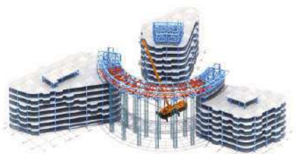
安装次桁架及其它杆件
