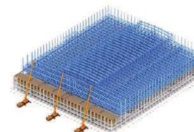
依次安装所有桁架
