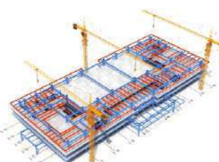
安装四层钢柱及钢梁
