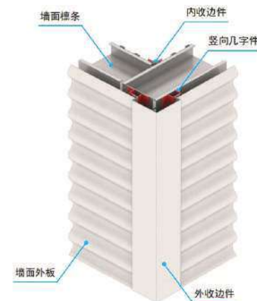
墙面转角节点轴测图
