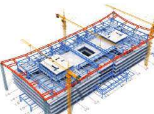
安装封边桁架
