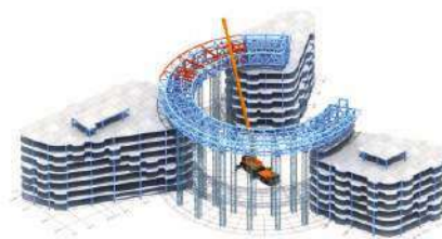
安装次桁架、补装其它杆件
