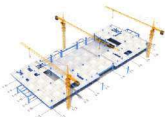
铺设楼承板并浇筑混凝土
