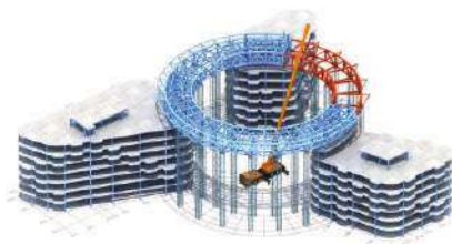
依次安装第三段空中桁架
