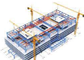
安装次桁架及连系梁
