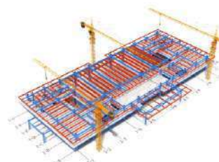
安装三层钢柱及钢梁
