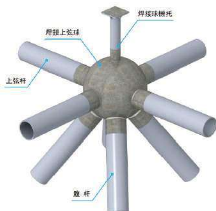
焊接球檩托连接节点轴测图
