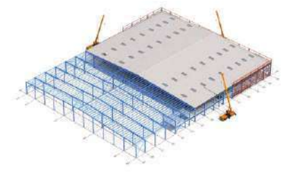
屋面板以及墙面檩条施工
