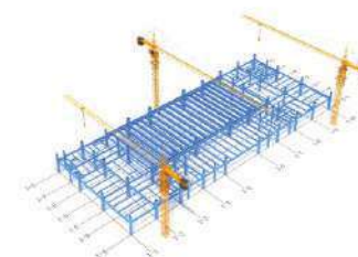
首层钢梁安装完成
