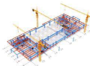
安装二层钢柱及钢梁
